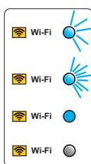
**Lampeggio lento** – Collegamento in standby (se l'interfaccia Wi-Fi è attivata)
