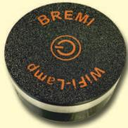
La funzione di Led/buzzer WiFi portable consiste nel replicare a distanza le indicazioni visive e sonore degli stati di sicurezza dei dispositivi EV-SAFE ed EV-SAFE Rescue. La portata tipica per la ricezione del segnale Wifi generato da EV-SAFE, è quella di una rete Wifi standard in condizioni ottimali in campo aperto: circa 20m.
