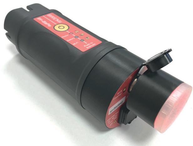
**ATTENZIONE!** Il verso di inserimento è univoco, non forzare e prestare attenzione al corretto orientamento della **tacca di riferimento** di Led/Buzzer on Board (verso l'alto);
